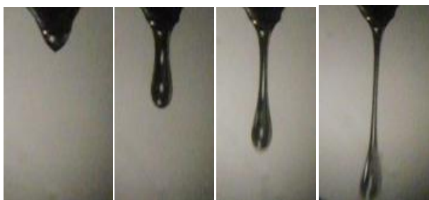
Рисунок 1 – Процесс отрыва капли при напряжении 13,4 кВ
