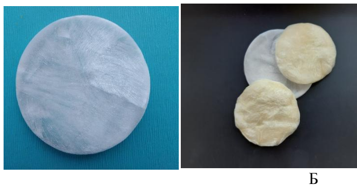
Рисунок 1 – Полученные образцы губок: А – КМЦ-Na, модифицированная лимонная кислота, Б – губки содержащие в своем составе янтарную кислоту, глутаровый альдегид и рутин
